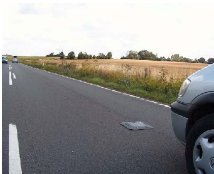
Figur 2.6: HiStar plade med dækmåtte monteret på vejoverflade.
