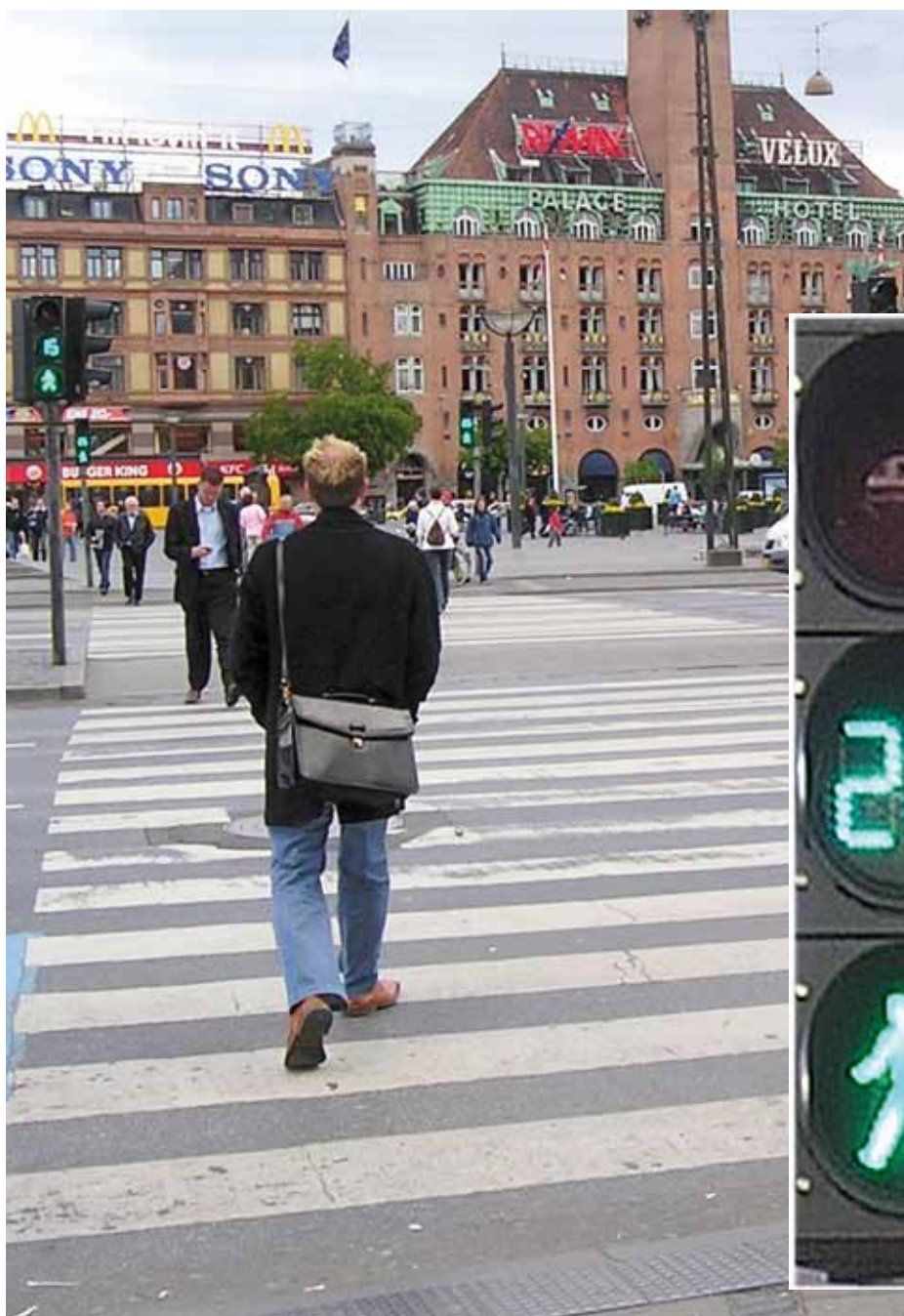
◀ Figur 3. Fodgængerovergang med nedtællingssignal.
