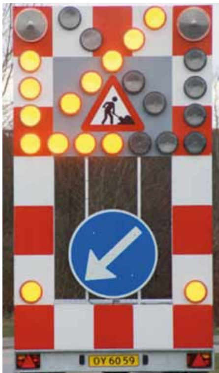
Figur 2B. Lyspil, Lukning af højre vognbane.
