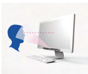
Figur 4. Eksempel på en stationær, transportabel eye tracker, som er placeret nederst på PC-skærmen (SMIvision.com 2017).
