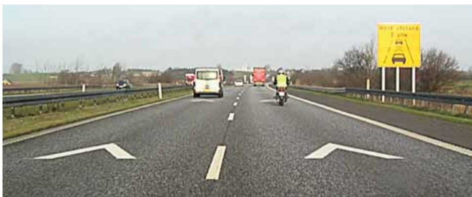
Figur 4. Eksempel på afstriking med afstandsmærker.
