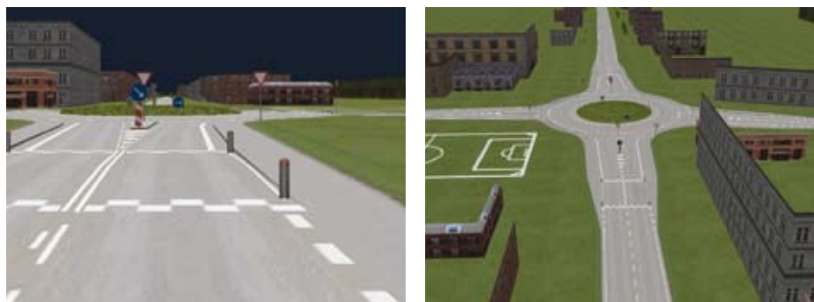
Figur 3. Rundkørsel med acceptable oversigtsforhold. Her er plantet træer i tilfarten med en indbyrdes afstand på 6 m. Højde på midterø er 1,90 m inkl. beplantning.
