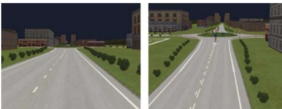
Figur 2. Eksempel på rundkørsel med middelgode oversigtsforhold. Højde på midterø er 1,5 inkl. beplantning. Højde af buske i tilfarten er 0,8 m.
