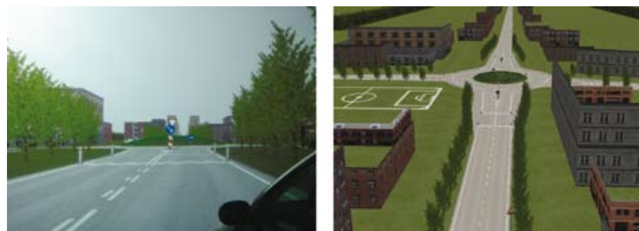
Figur 4. Rundkørsel med gode oversigtsforhold. Her er ingen beplantning langs tilfarten. Højde på midterø er 1,0 m inkl. beplantning
