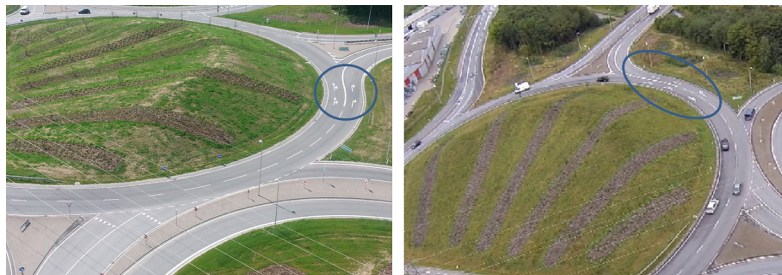
Figur 2. Foto til venstre: Forholdsvis mange trafikanter erkender først sent i forperioden, at de kører i et tvungent højre spor (rød stiplede linje). For at fortsætte videre rundt i rundkørslen foretager trafikanterne derfor et sent uhensigtsmæssigt vognbaneskift mod venstre over fuldt optrukket linje. Foto til højre: Problemet blev afhjulpet ved at forstærke afmærkningen med et tredje sæt pile (blå ring) samt tydeliggørelse af vejvisningen ved kørsel frem mod rundkørslen.
