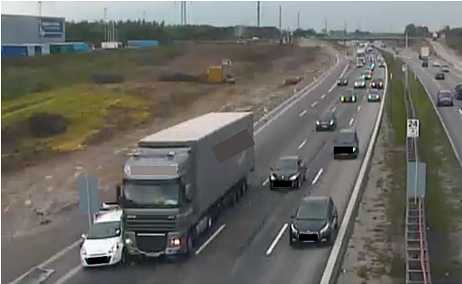
Figur 3. En rampetrafikant bliver klemmt af lastbil fra motorvejen i forbindelse med indfletning fra rampe.
