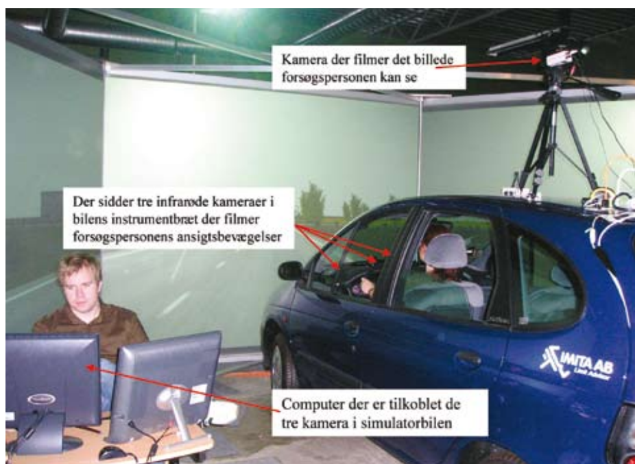
Figur 1. Simulatorbil med eyetrackersystem. Eyetrackeren består af tre videokameraer der filmer forsøgspersonernes ansigt under kørslen. Kameraerne er placeret ved instrumentbrættet inde i bilen, og er tilsluttet en computer, som bl.a. ud fra optagelserne laver en beregning af forsøgspersonernes blikpunkt.
