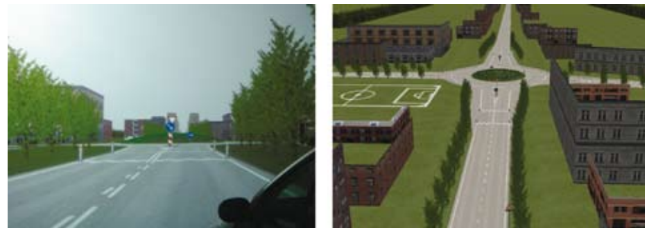
Figur 4. Rundkørsel med gode oversigtsforhold. Her er ingen beplantning langs tilfarten. Højde på midterø er 1,0 m inkl. beplantning
